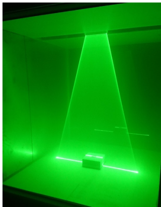
Fig 1. Visualisation du panache par technique laser
