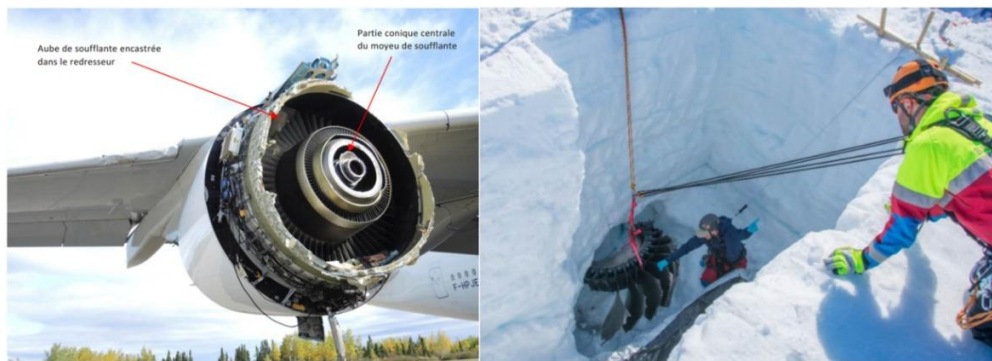
Photographies de moteur après perte du disque fan en titane (à gauche) et la pièce retrouvée au Groenland (à droite) illustrant la persistance des problématiques de fatigue (rapport d'enquête du BEA 2020)
