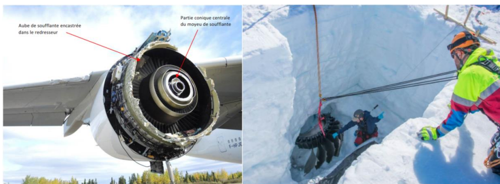
Photographies du moteur après perte du disque fan (à gauche) et du disque fan retrouvé au Groenland (à droite) [1]
