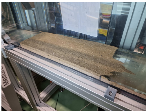
Essais d'érosion en canal hydraulique
