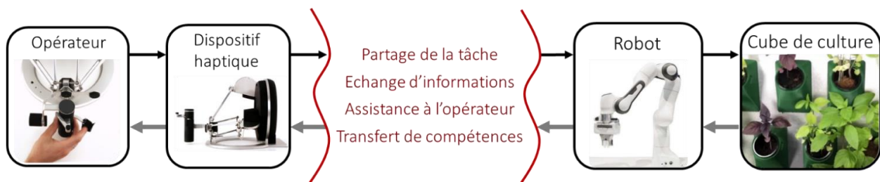
Figure 2. Schéma de contrôle pour l'assistance, un couplage évolutif entre le robot et l'interface de téléopération.
