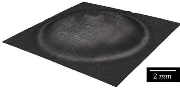
Echantillon d'Al 100\mu\text{m} d'épaisseur soumis à un flux laser impulsionnel de 32\text{ns} , confiné de 0,3\text{GW}/\text{cm}^2
