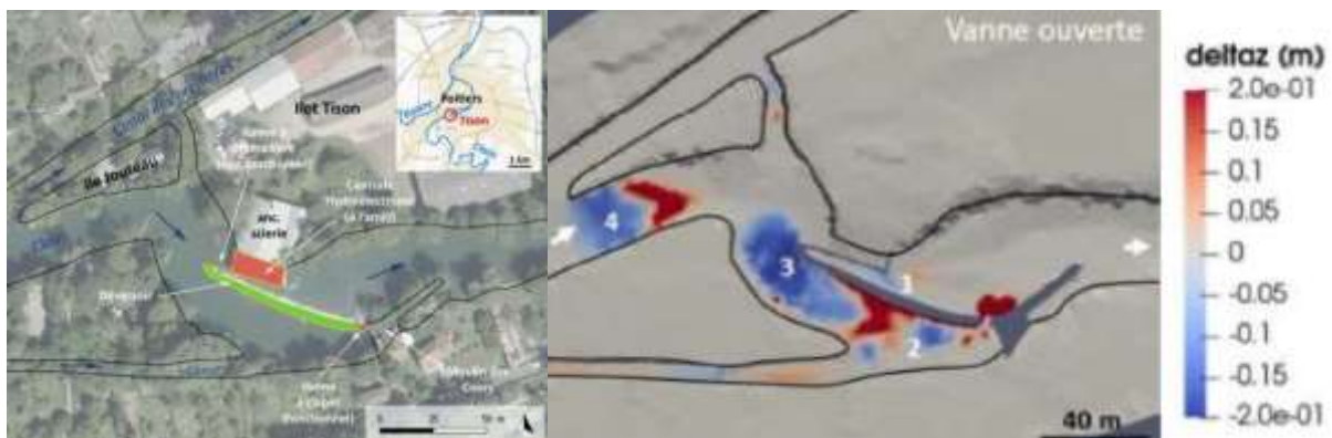
Fig. Plan de l'ouvrage transversal « Moulin des Cours et Scierie de Tison » et variation de la topographie lors de l'ouverture de la vanne de chasse.
