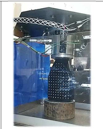
Essai de pression interne sur réservoir composite
